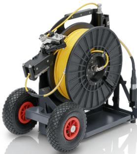
Tamburo avvolgicavo da 150 metri motorizzato e sincronizzato con i movimenti del carro. Dotato inoltre di sensore contametri e dipanatore automatico per un riavvolgimento impeccabile.
