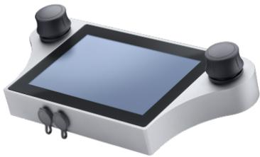
Display da 10", resistente agli spruzzi (IP43), idoneo per impegno diurno alla diretta luce solare. Monitor "touchscreen" e doppio joystick per poter gestire il sistema come si preferisce.
