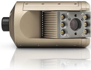
Telecamera a testa rotante a 360° in modo continuo, radialmente a circa +/- 120°, con funzione autolivellante. Illuminazione regolabile con LED. Messa a fuoco manuale o automatica (solo ORPHEUS). Trasmettitore integrato a 33 kHz per la localizzazione a distanza. Laser opzionale integrato per la misurazione di diametri e difetti. Monitoraggio della pressione interna. A richiesta, con certificazione Ex.
