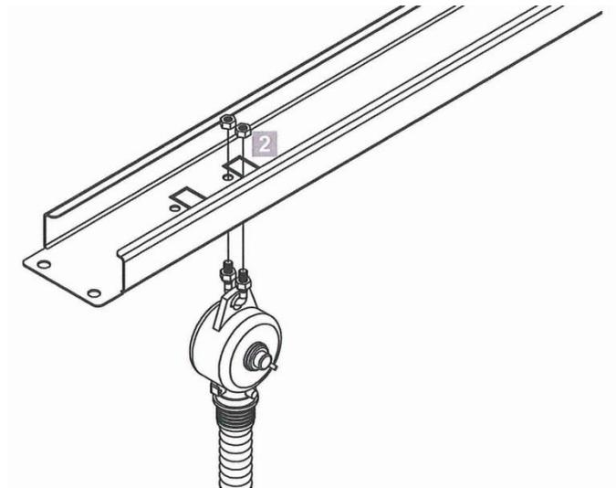
Montare l'avvolgitore destro alla traversa
